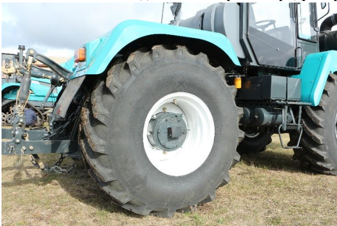
Рис. 2. Датчик динаміки колеса, встановлений на бортовий редуктор колісного трактора
