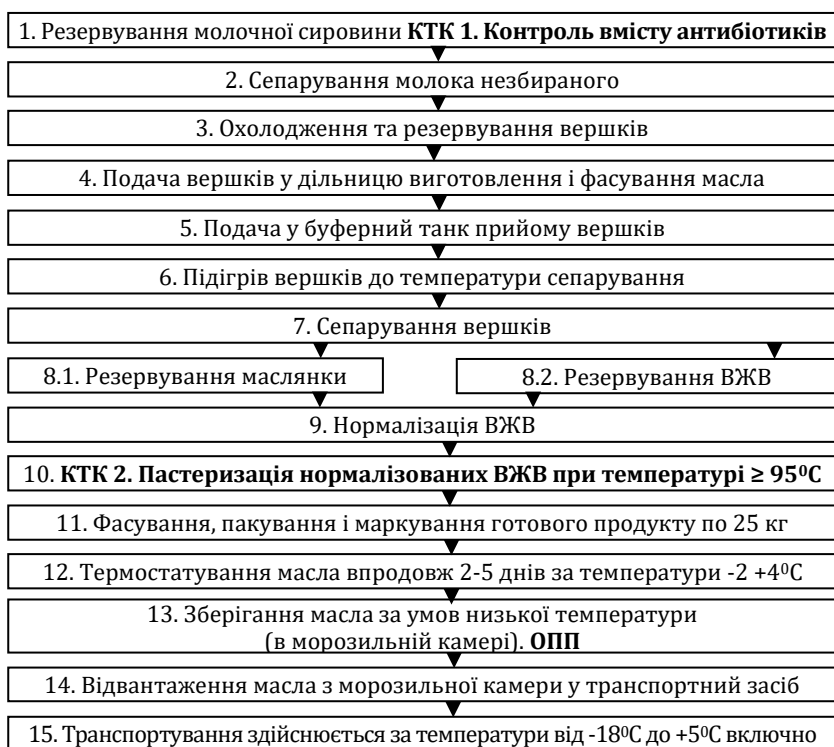
Рис. 1. Приклад блок-схеми виробництва масла солодковершкового. Джерело: розроблено автором
