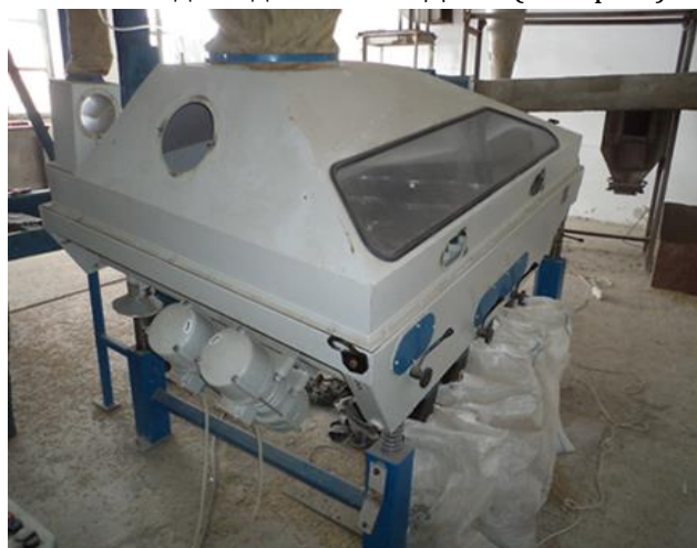
Рис. 2. Лабораторні дослідження процесу розділення НМ на пневмосепарувальному столі
